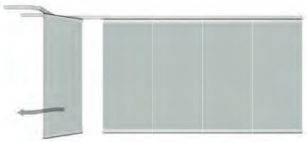
Eindreihen des Öffnungsflügels Turning of the opening panel
