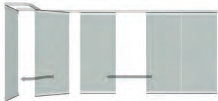
Verschieben der Flügel zur Öffnungsseite Sliding the panels towards the opening side
